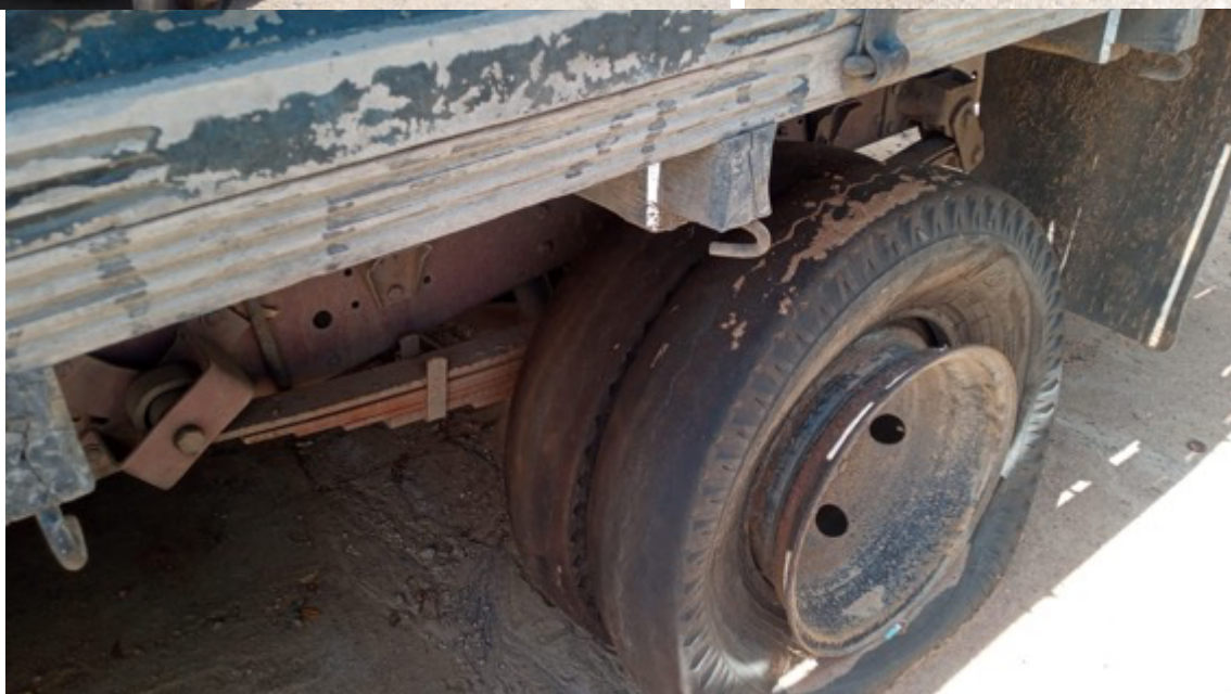
(IVECO FIAT DAILY 4916 C PLACA JFP 6134 ANO/MOD 2002/2002 – Pneus em grave estado de deterioração)
