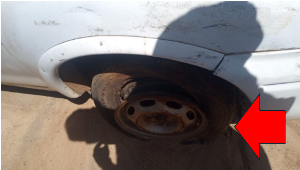
(CHEVROLET GM CORSA PLACA JKZ 7826 – pneus em alto grau de deterioração)
